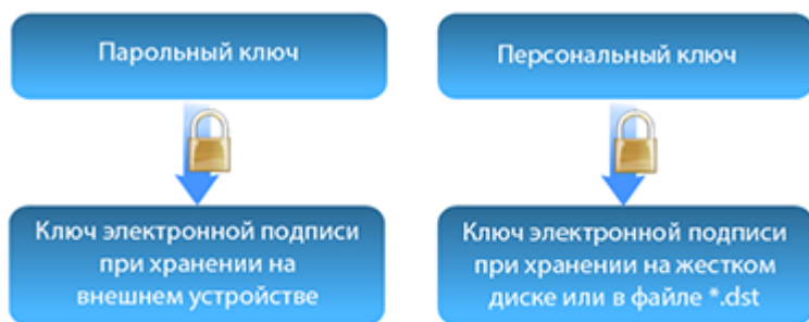
Рисунок 164. Схема защиты ключа электронной подписи
