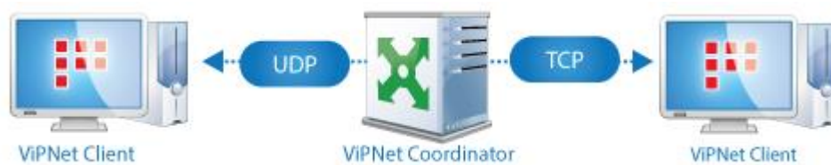
Рисунок 36. Сетевые узлы соединяются через межсетевой экран
