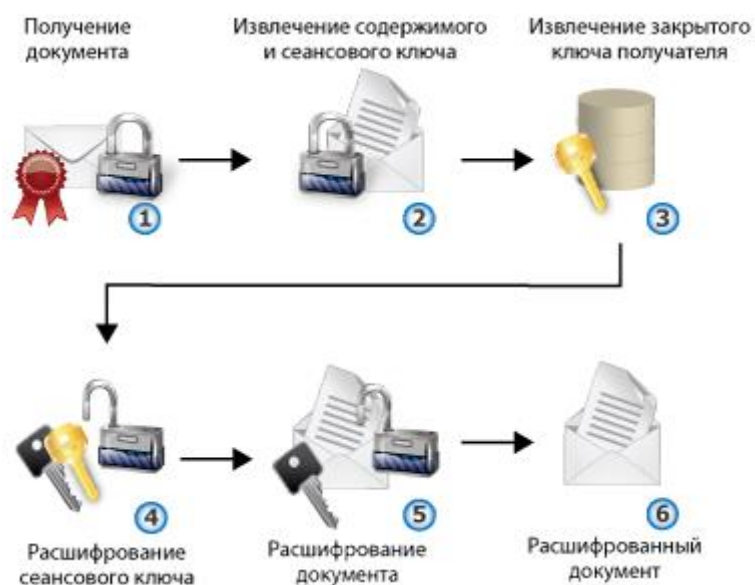
Рисунок 157. Процесс расшифрования электронных документов
