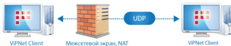
Рисунок 35. Сетевые узлы соединяются через межсетевой экран
