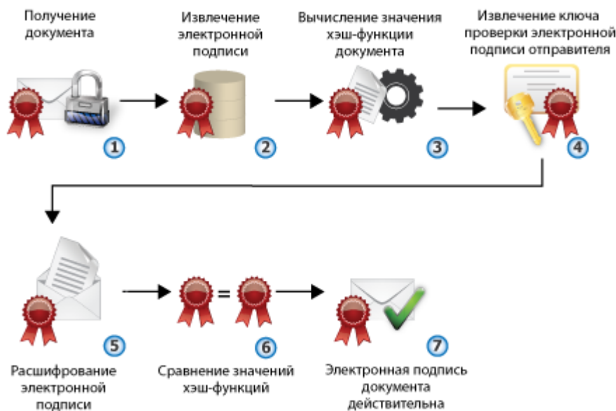
Рисунок 159. Процесс проверки электронной подписи
