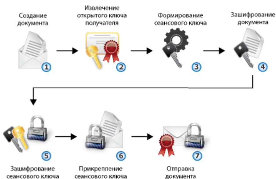
Рисунок 156. Процесс зашифрования электронных документов
